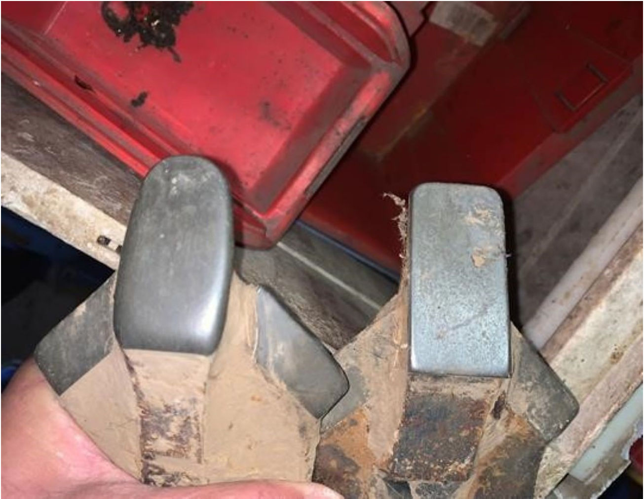
Abbildung 1: Pflugschare ohne (links) und mit (rechts) aufgelöteter Hartmetallplatte
